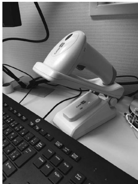
図1 RIS 端末に設置したバーコードリーダー (バーコードを読み、PCには手入力しない)
